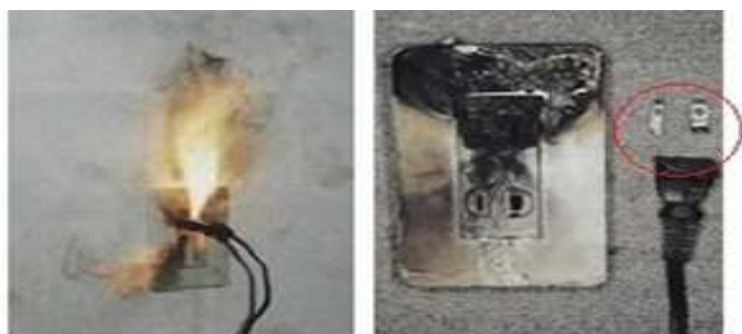
【図 16】 差込中プラグと刃溶損プラグ[7]
