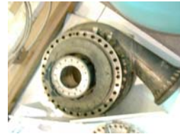
第1段エンジン液体水素ターボポンプ
