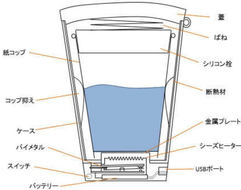
紙コップを内蔵できる携帯用のホルダーで、外付けのケーブルをPCなどの電源につなぐことでシーズヒーターにより加熱が出来る。過熱の際、コップ底部近くのバイメタルにより自動的に適温で加熱が終わる制御となっている。ホルダー壁面には断熱素材が用いられており、熱の出入りがしにくい構造となっているため、熱い飲み物でもつめたい飲み物でも温度を維持しやすい。紙コップホルダー上部のばねつきのシリコン製の栓により、傾けたり、持ち歩く際横倒しにしても内容物がこぼれない構造となっている。バッテリー内蔵の為、電源のない時でもいつでも加熱を行うことが出来る。ホルダー内部の側面に弾力性のある紙コップ抑えを取り付けることで、外部からの衝撃がコップに伝わらない構造とした。
