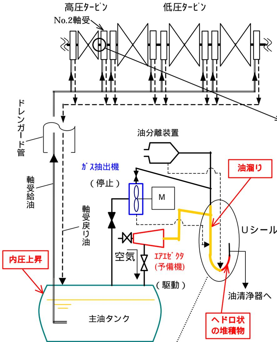
〔高圧タービン軸受漏油受取付図〕
