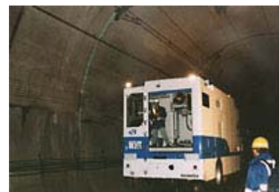
図 5 . SATUZO による検査 （出典；JR 西日本 HP）
