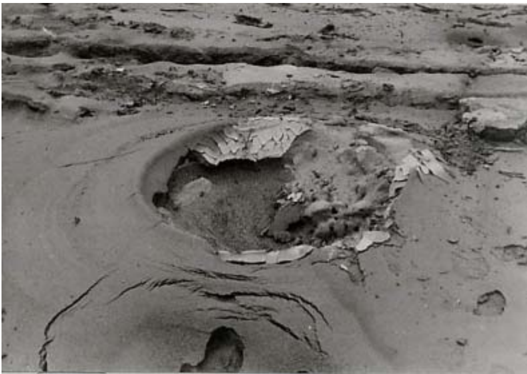
Fig. 4 Liquefaction of ground (Kawagishi-cho).
